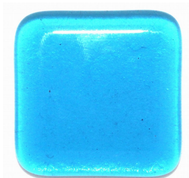
2 kerrosta, 6 mm ei muodonmuutosta, / pyörityneet kulmat
