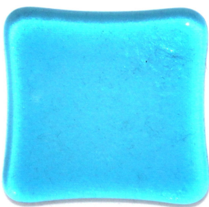
1 kerros, 3 mm lasi on vetäytynyt sisäänpäin
