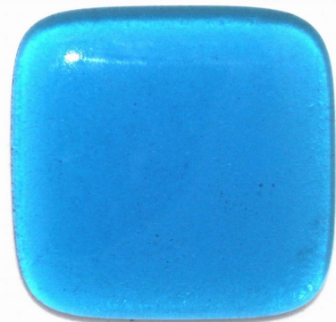
3 kerrosta, 9 mm asi on suurentunut ja laajentunut
